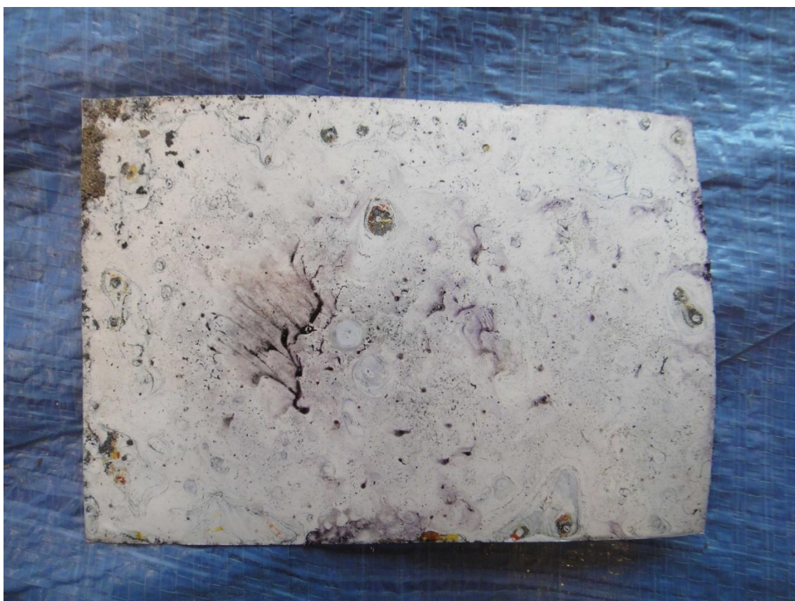
写真の画像面が腐食劣化で消えて白紙となってしまうもの
